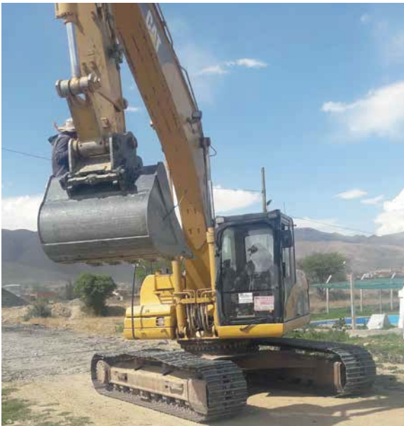
Apoyo de pala para el movimiento de material de cobertura
