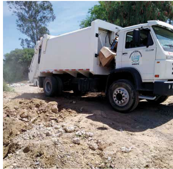
Camión compactador (recolector solo de desecho)
